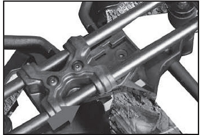
15. Faites glisser le carquois sur le support en le poussant vers le haut.
