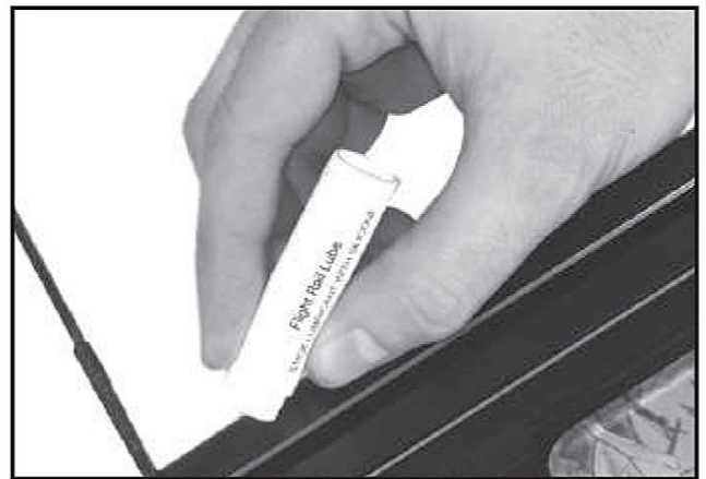
28. Avant toute utilisation, lubrifiez le tranche-fil et le rail. Si vous ne le faites pas, vous risquez de brûler et d'user prématurément le tranche-fil. Nous vous recommandons d'appliquer de la cire tous les 10 à 15 tirs.
